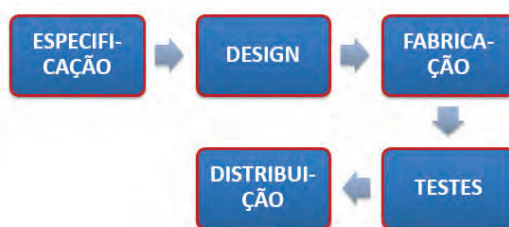
Figura 3 - Etapas da fabricação de um circuito integrado. Adaptado de Villasenor (2013).
